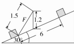
**解析** 因为绳索长 1.5 m, 拖拉点距斜面的垂直高度为 1.2 m, 斜面坡度为  $30^\circ$ ,
