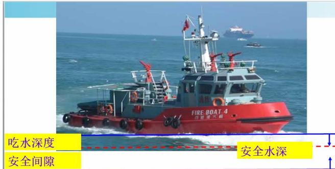
由图中可以看出：只有当“实际水深  $\geq$  吃水深度+安全间隙（即安全水深）”时，货船才可以进去或离开港口。
